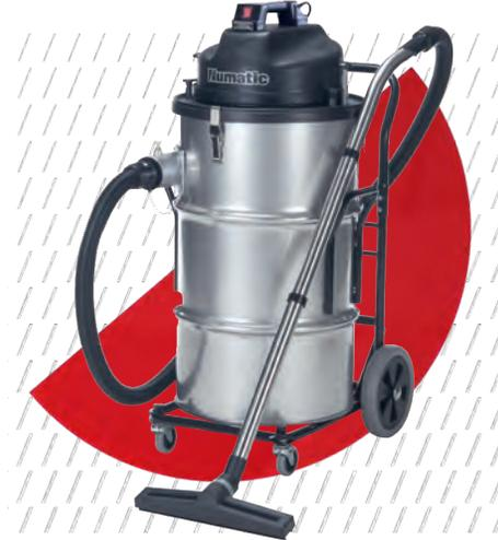
Aspirateur industriel grande capacité, 2 moteurs By-pass à turbines 2 étages, Système d'aspiration cyclonique qui centrifuge les particules aspirées : réduction du risque de colmatage prématuré, Cuve en acier époxy sur châssis renforcé, 2 poignées latérales : vidange aisée, Secoueurs de filtre intégrés (système manuel), Système NUPLUG pour un changement de câble sans outil.
