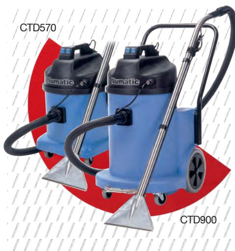
Aspirateurs eau et poussières, injecteurs/extracteurs : la solution eau-produit est directement injectée sur la surface à traiter pendant que l'eau sale est aspirée vers la cuve, Équipés de 2 moteurs by-pass à turbine 2 étages, Pression de la pompe jusqu'à 5 bars, Cuves et têtes en Structofoam, cuve garantie 3 ans, Système NUPLUG pour un changement du câble sans outil. **L'aspiration et l'injection se font ensemble ou séparément.**
